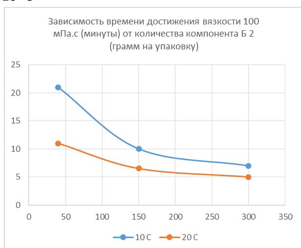
Зависимость времени гелеобразования (минуты) от количества инициатора компонента В (в граммах) при температурах 10 и 20 °С
